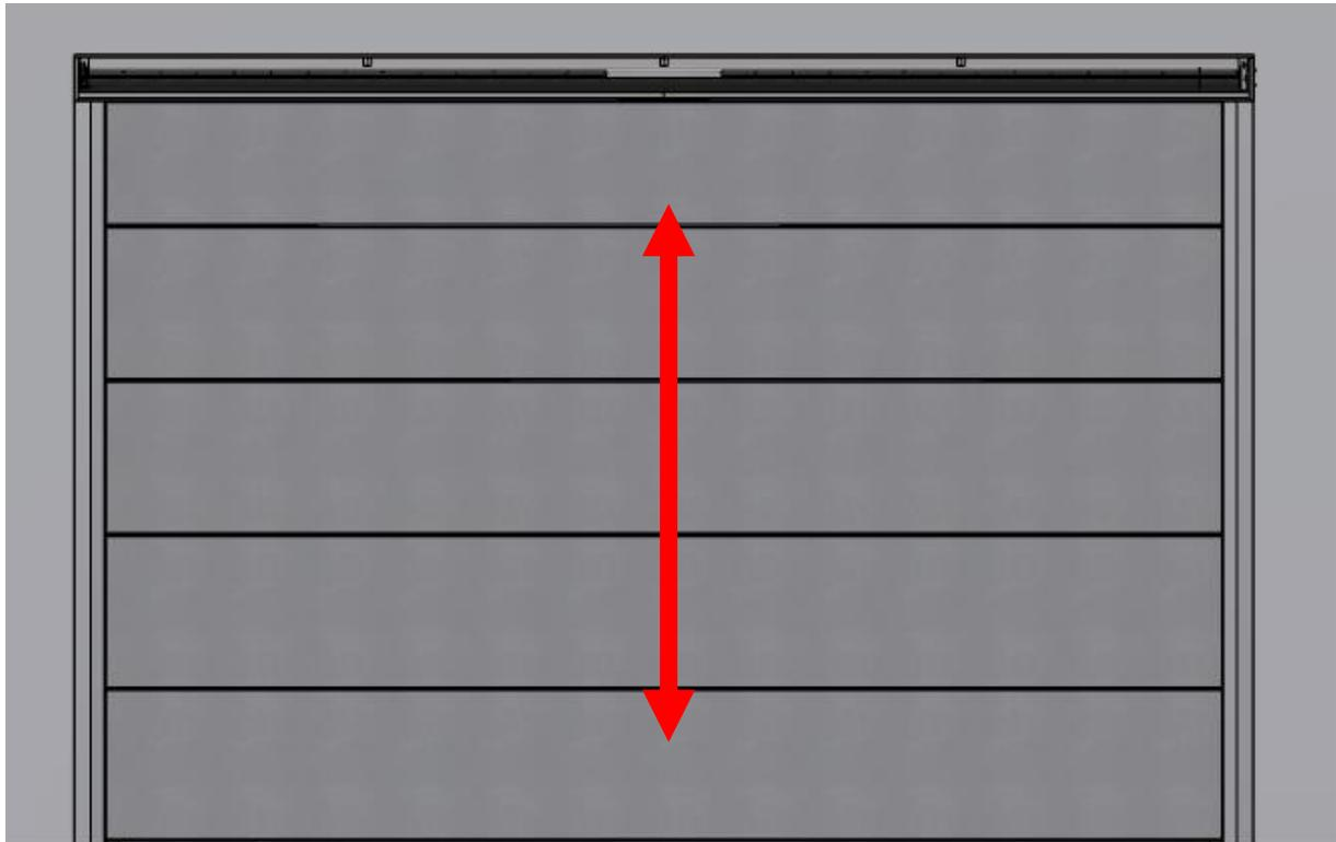
Pour éviter ce problème, il faut enrouler le tissu à 500 mm sous l'enveloppe pendant 10 secondes pour permettre à l'air de s'échapper. Après cela, le tissu peut être ouvert davantage. Gardez un œil sur le tissu et arrêtez si une autre poche d'air se développe pendant 10 secondes.
