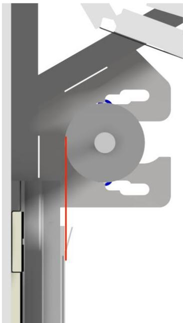
Spingere gli anelli di regolazione contro i cuscinetti e serrare le viti di bloccaggio. Serrare le viti dei cuscinetti. Controllare se il rullo di pressione è parallelo e in piano, se necessario regolarlo.
